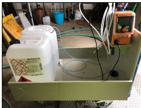
Chariot mobile de dosage d'acide phosphorique avec pompe intégrée
