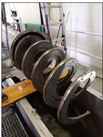
Ancienne brosse d'entrée d'ouvrage
